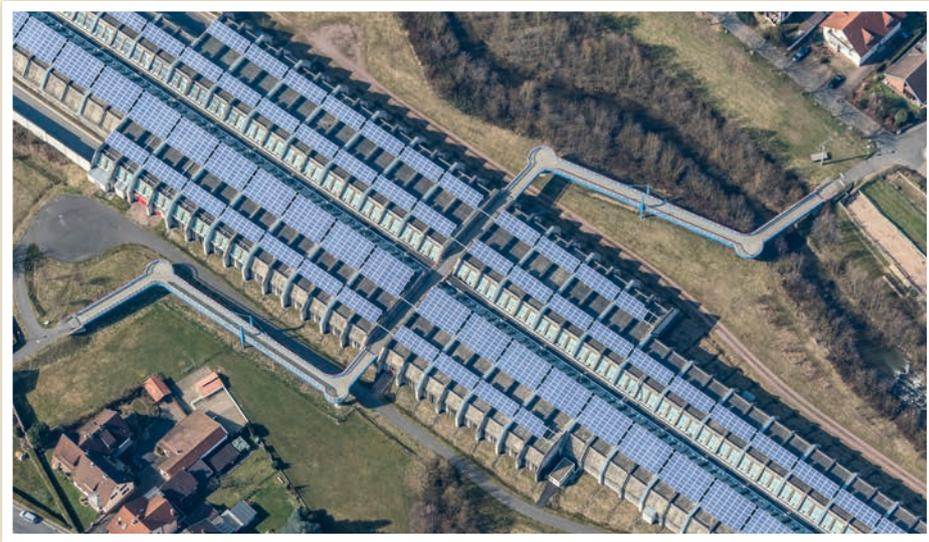
Photovoltaikanlage auf der eingehausten A3 bei Goldbach
