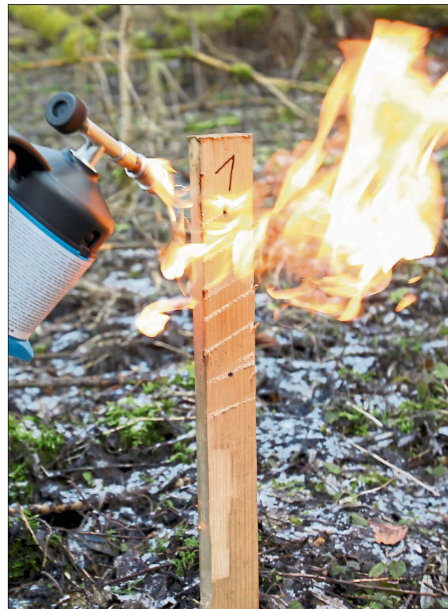
Um sicher gehen zu können, dass keine Gensuren das Ergebnis verfälschen, werden die Latten abgeflammt.
