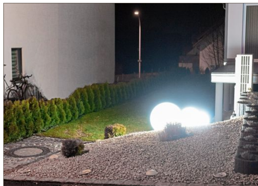
Weit weg von einer insektenschonenden Beleuchtung sind diese Gehweglampen. Das Licht verteilt sich kugelförmig, der Fußgänger wird geblendet. Für Heinrich Inkoferer eine „Lichtverschwendung“. Foto: Heinrich Inkoferer
